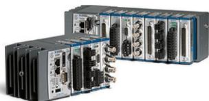
CompactRIO 将开放嵌入式架构与小巧、坚固以及 C 系列模块进行了完美融合，是一种由 NI LabVIEW 驱动的可重配置 I/O (RIO) 架构。每个系统包含一个 FPGA，用于自定义定时、触发以及处理一系列可用的模块化 I/O，可满足任何嵌入式应用程序的需求。
